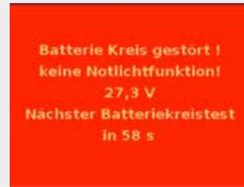
Die Zentrale überprüft in der Statusanzeige ständig die ordnungsgemäße Ladung der Batterien <5min. Bei Unterbrechung erfolgt eine kritische Fehlermeldung. Der Batteriebetrieb ist nicht gewährleistet.
