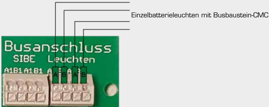
An das LPS-Gerät können zusätzlich bis zu 20 Einzelbatterieeleuchten mit Busbaustein –CMC überwacht werden. Die Versorgung der Einzelbatterieeleuchten erfolgt weiterhin über eine Einspeisung einer festen Phase hinter der Absicherung der zugeordneten Allgemeinleuchten.
