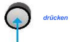
Durch Drücken des Drehknopfes und anschließendes Drehen lässt sich die Einerstelle einstellen.
