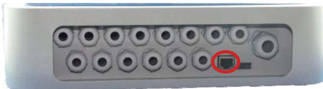
Hier kann die Anlage mit einem Netzwerkschicht verbunden werden. Eine Verbindung im Intranet kann über eine Standard - VNC Software hergestellt werden. Bei Freigabe des Ports 5900 kann ein Zugriff aus dem Internet erfolgen. Bitte wenden Sie sich bei Netzwerkfragen an den zuständigen Systemadministrator.
