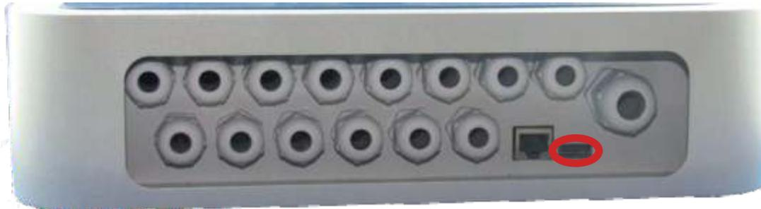
Hier kann ein USB- Drucker, eine USB-Tastatur oder ein USB - Speicher angeschlossen werden. Die angeschlossenen Geräte werden automatisch erkannt.
