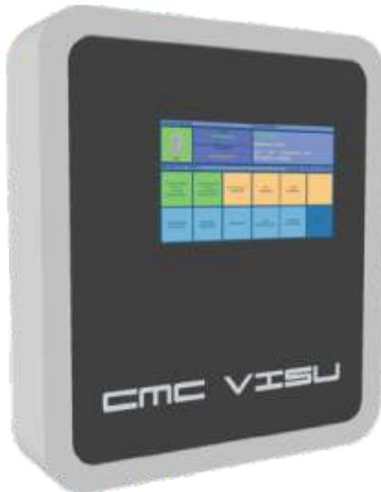
Vollautomatische Prüfeinrichtung, zur Programmierung und Überwachung von Einzelbatterie- und LPS Systemen. Redundanter Speicher zur Protokollierung von Zustandsänderungen und Testergebnissen der angeschlossenen Systeme.
