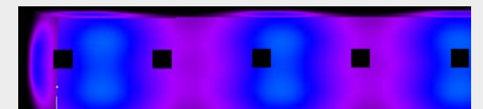
DALI-Aufteilung mit Dimmung: Gleichmäßige, ausreichende Ausleuchtung und Energiereduktion bei uneingeschränkter Erfüllung der Norm.
