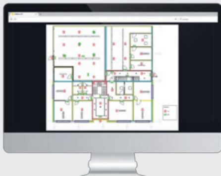
Durch die Gebäudevisualisierung erhalten Sie eine optische Ansicht der Sicherheitsbeleuchtung im Gebäude. Die Visualisierung ermöglicht dem Benutzer eine schnelle Übersicht über alle an der Zentrale angeschlossenen Verbraucher.
