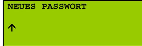
Sie können bis zu 8 Zahlen eingeben. Die Bestätigung des Passwortes erfolgt über **ENTER**. Das Passwort kann über die Eingabe 00000000 (8X0) gelöscht werden.
