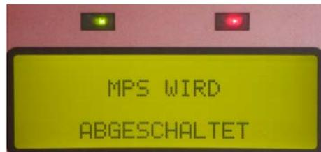
Alle Programme werden geschlossen. Blinken alle LEDs am Display, kann der Rechner spannungslos geschaltet werden.
