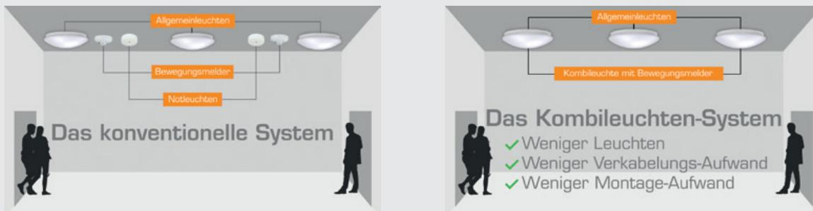
Der Grund war auf der architektonischen Seite die überladenen Decken mit den verschiedenen elektronischen Komponenten wie Allgemeinleuchten, Notleuchten, Bewegungsmeldern, Brandmeldern usw. als ästhetische Komponente und auf der technischen Seite der geringere Verdrahtungsaufwand verbunden mit der niedrigeren Brandlast.
