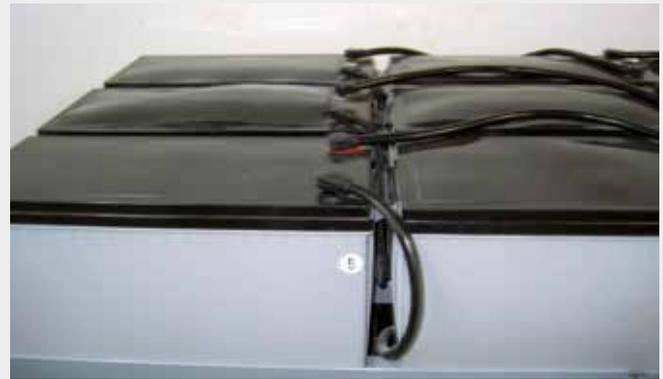
Verschlossene Bleibatterien gem. DIN EN 60896-2 mit Hitzeschäden
