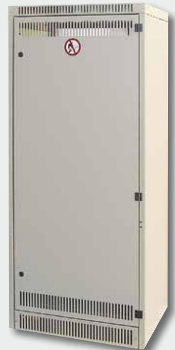
Alle Gehäuse werden pulverbeschichtet und einbrennlackiert produziert. Alle Gehäuse entsprechen der Schutzart IP 20. Die Türen sind rechts angeschlagen. Die Türen der Standgehäuse sind in einem Winkel von 180° zu öffnen. Zur Anpassung an andere Gehäuse können zusätzlich Gehäusesockel von 100 bzw. 200 mm Höhe geliefert werden.
