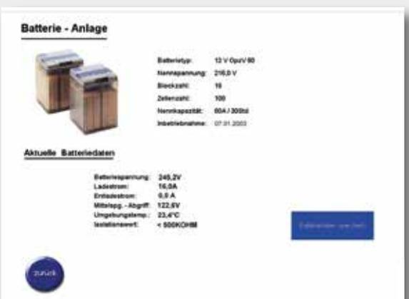
Das Visualisierungssystem ermöglicht eine zentrale Überwachung und Bedienung von Sicherheitslichtanlagen mit folgenden Funktionen:
