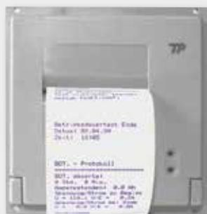
Das Ende der Störungen wird mit Angabe von Datum und Uhrzeit ausgegeben. Nach Ablauf eines Kurztests oder eines Betriebsdauertests werden die Resultate und Messwerte mit Angabe von Datum und Uhrzeit ausgegeben.
