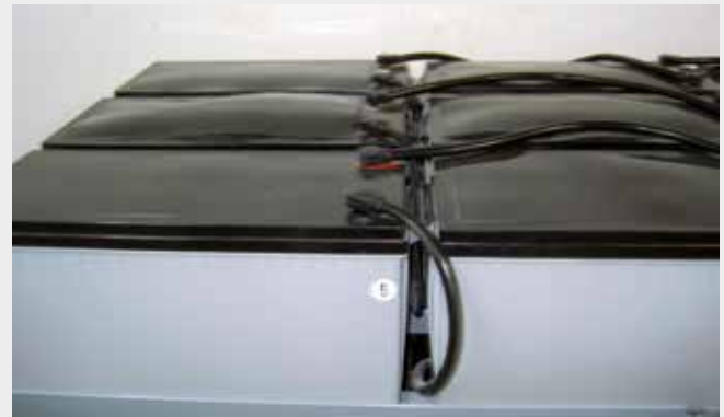
Verschlossene Bleibatterien gem. DIN EN 60896-2 mit Hitzeschäden
