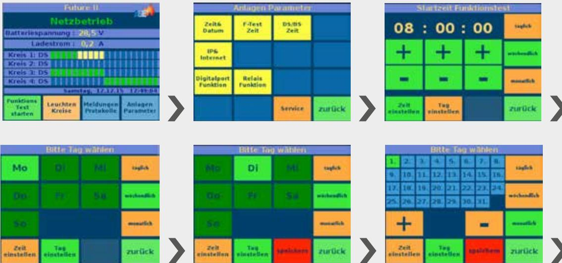
Entsprechend den aktuellen Vorschriften muss mindestens ein wöchentlicher Funktionstest durchgeführt werden. Ist das Gerät autark, muss der Funktionstest aktiviert und die Testzeit eingestellt werden.
