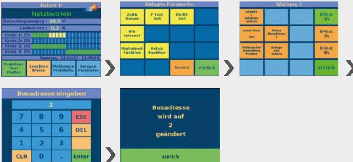
Wenn das LPS-Gerät an eine übergeordnete Überwachungszentrale CMC-40 oder CMC-VISU angeschlossen wird, bekommt das Gerät eine Busadresse von 1 bis 40 (CMC-40) oder 1-60 (CMC-VISU). Diese wird erstmalig bei der Erstinbetriebnahme festgelegt, kann aber entweder nachträglich im LPS geändert werden oder von der CMC-40/CMC-VISU vergeben werden.
